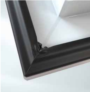
La technologie de joints habituelle forment des coins durs lors du soudage. Cela entraîne une perte d'élasticité et donc une étanchéité moindre.
